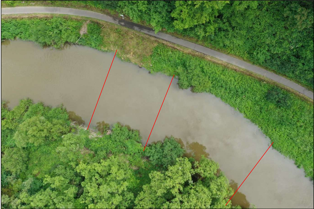
Abb. 26: Querprofile 5 bis 7 im dritten Abschnitt der Ausleitungsstrecke bei einem Abfluss von 6 m 3 /s.
