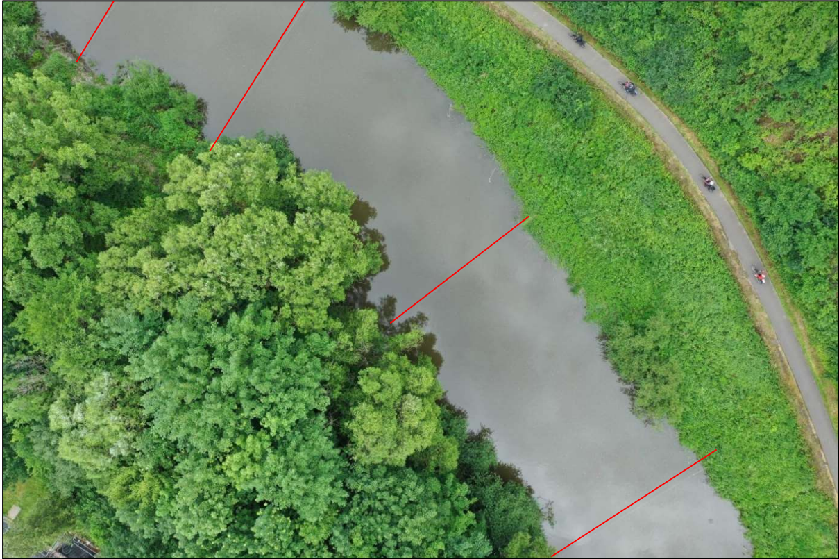
Abb. 22: Gleichförmiger Abfluss mit geringen Strömungsgeschwindigkeiten im dritten Abschnitt der Ausleitungsstrecke bei einem Abfluss von 4 \text{ m}^3/\text{s} (Querprofile 4 bis 7 von links nach rechts).
