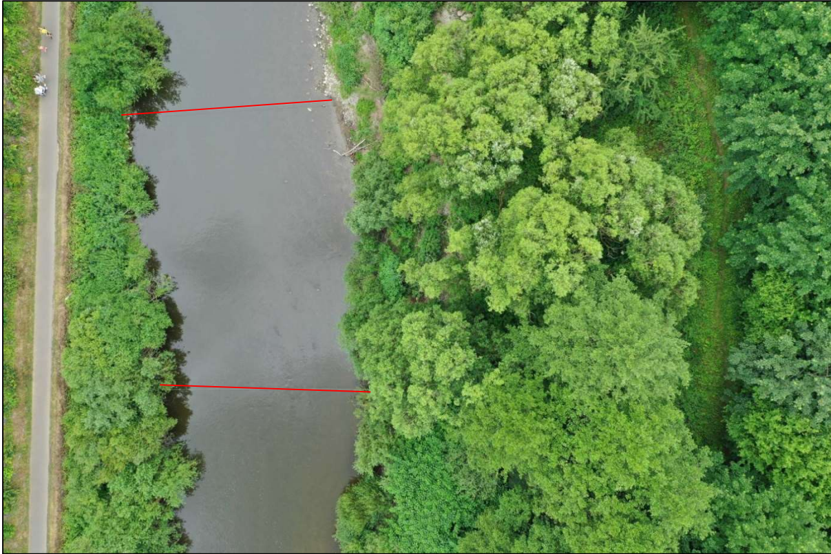
Abb. 17: Querprofil 2 (unten) bei 2 m 3 /s mit potentiell überströmten Habitaten für rheophile juvenile Fischarten auf rechter Uferseite und Querprofil 3 (oben) mit weitgehend stagnierenden Abflussverhältnissen auf der rechten Uferseite.
