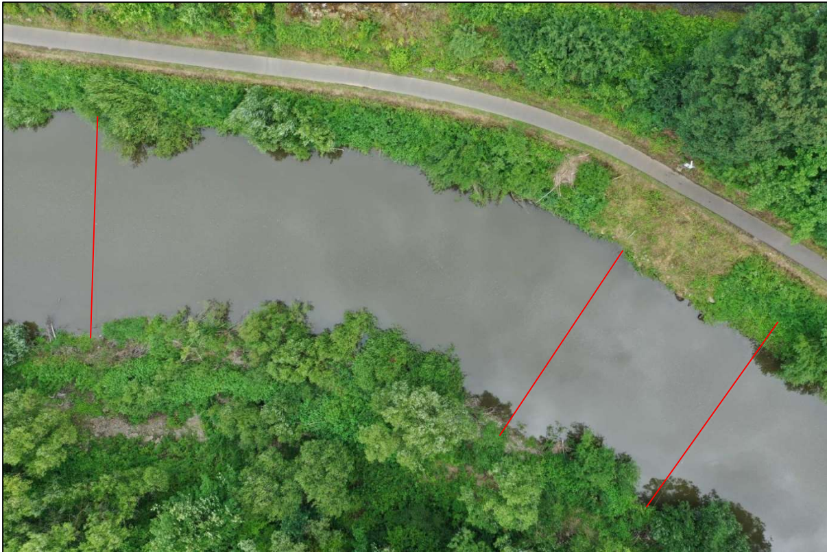
Abb. 21: Potentielle Flachwasserhabitate der Querprofile 2 (links) und 3 (Mitte) verschwinden bei einem Abfluss von 4 m 3 /s. Querprofil 4 (rechts) ändert sich kaum (s.u.).
