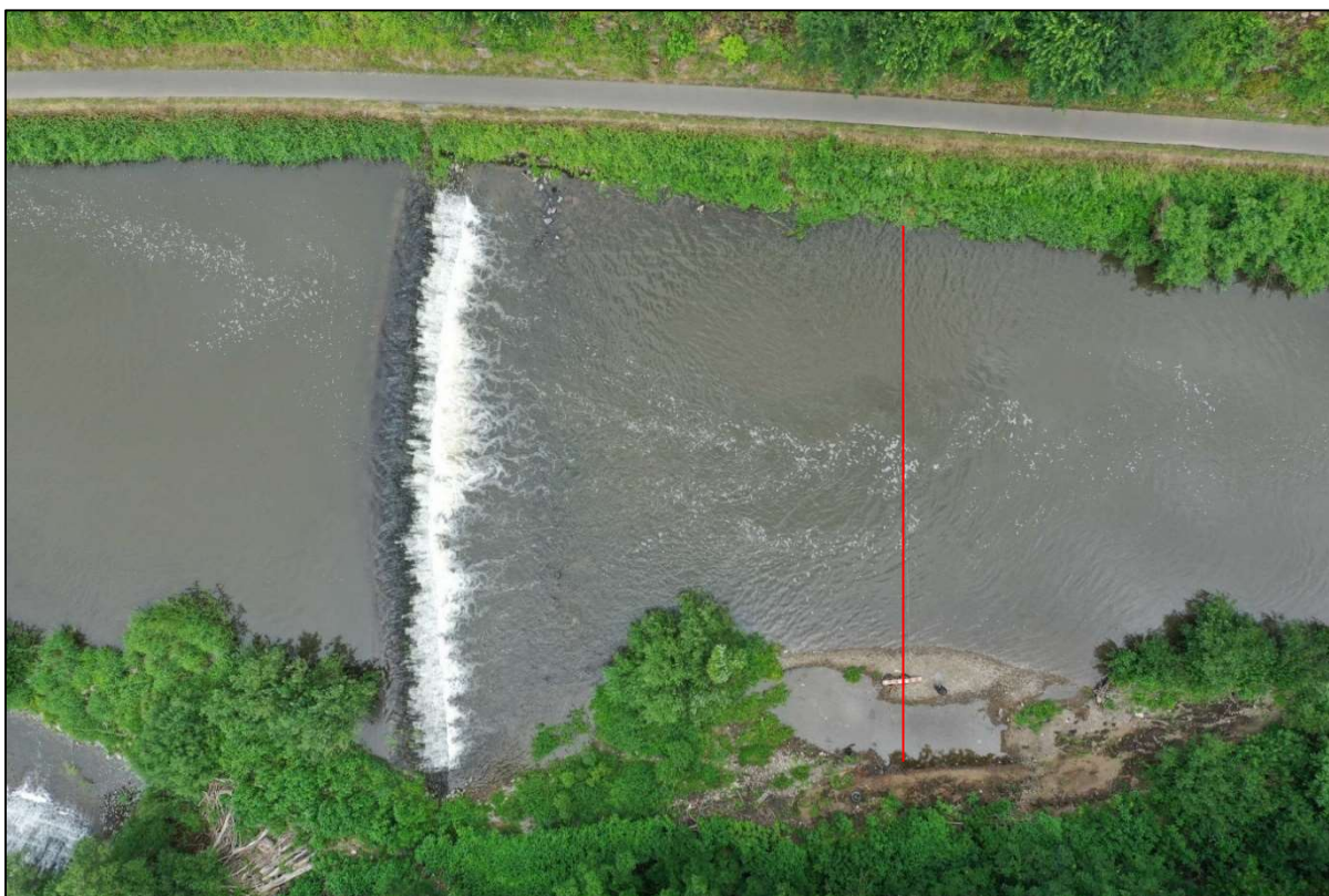
Abb. 20: Kiesbank auf rechter Uferseite am Querprofil 1 wird bei einem Abfluss von 4 \text{ m}^3/\text{s} umspült, und eine zusätzliche Bucht entsteht.
