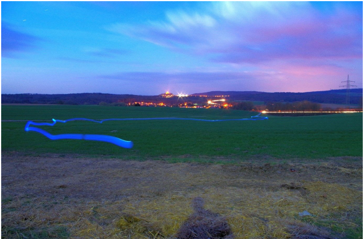
Abbildung 17: Langzeitbelichtung: Zugbahn (Trajektorie) eines austarierten blau leuchtenden Ballons in der Kaltluftströmung. © iMA Richter & Röckle GmbH & Co. KG
