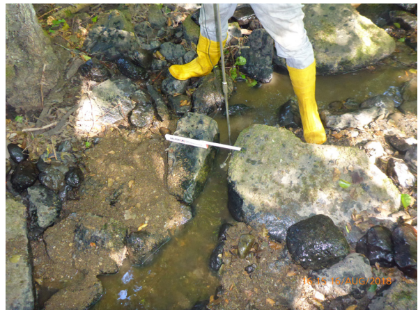
Abbildung 6: Niedrigwassermessung mit Messflügel. © RP Gießen
