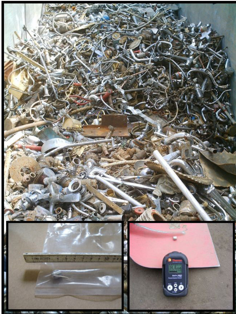
Abbildung 25: Beispielhafter Fund einer radioaktiven Quelle in einer Schrottverwertungsanlage. © RP Gießen
