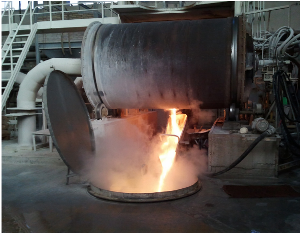
Abbildung 20: Ablassen einer 1500 °C heißen Glasschmelze in ein Wasserbad. © RP Gießen
