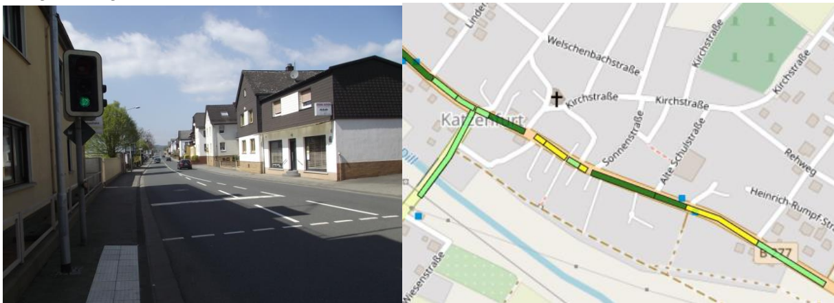
Abbildung 41: Bebauung entlang der B 277 im Ortsteil Katzenfurt (links) und Visualisierung des Lärmkonfliktpunkts B 277 im Nachtzeitraum durch normierte Lärmkennziffernbänder (rechts). 9190
