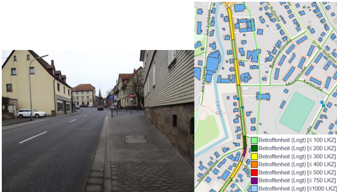
Abbildung 107: Bebauung entlang der B 275, Vogelsbergstraße, in der Kernstadt (links) Visualisierung des Lärmkonfliktpunkts im Nachtzeitraum durch normierte Lärmkennziffernbänder (rechts). 198/199
