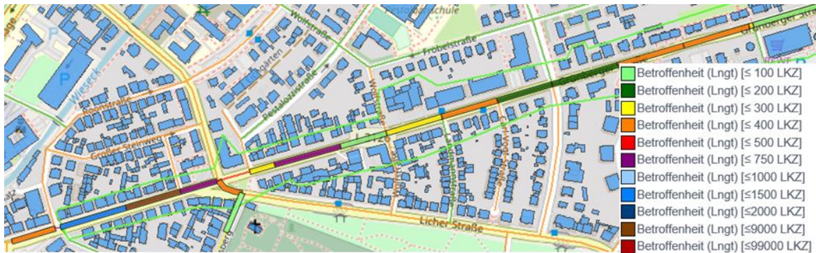
Abbildung 20: Visualisierung des Lärmkonfliktpunkts Grünberger Straße im Nachtzeitraum mit normierten Lärmkennzifferabschnitten. 58
