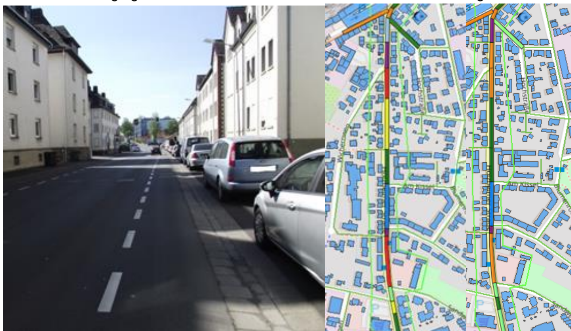
Abbildung 77: Bebauung entlang der L 3020 in der Kernstadt (links) Visualisierung des Lärmkonfliktpunkts im Nachtzeitraum durch normierte Lärmkennzifferbänder ohne nächtliches Tempo 30 (Mitte) und mit nächtlichem Tempo30 (rechts). 159/160
