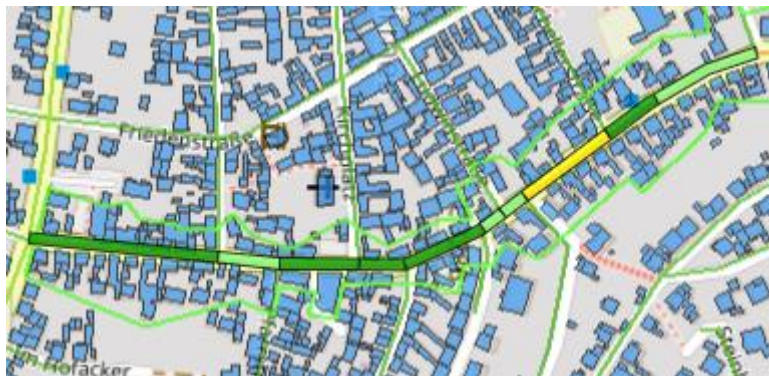
Abbildung 48: Visualisierung des Lärmkonfliktpunkts L 3286 im Ortsteil Waldgirmes im Nachtzeitraum durch normierte Lärmkennziffernbänder. 103
