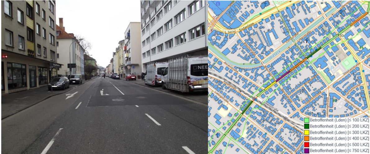
Abbildung 22: Lärmkonfliktpunkt Ludwigstraße mit charakteristischer Wohnbebauung (links) und Visualisierung des Lärmkonfliktpunkts mittels normierter Lärmkennziffer im Ganztagszeitraum (rechts). 5960
