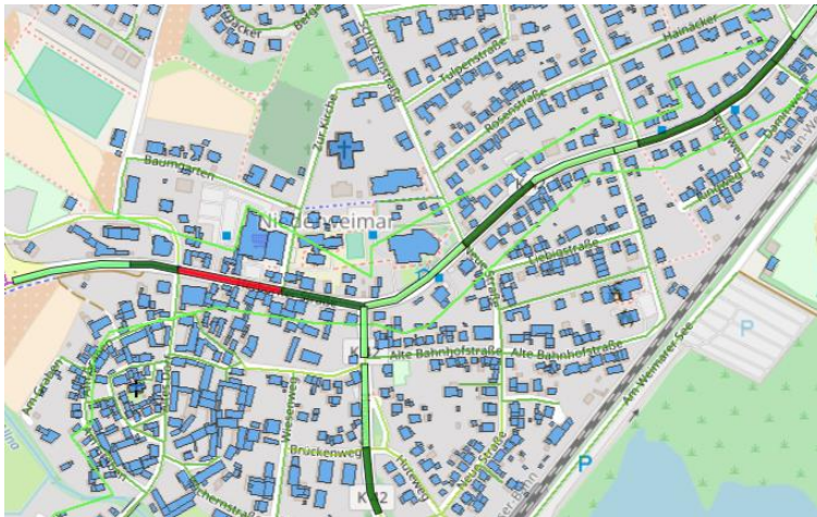
Abbildung 101: Visualisierung der Lärmbelastung im Nachtzeitraum durch normierte Lärmkennzifferbänder in der Gemeinde Weimar OT Niederweimar. 189
