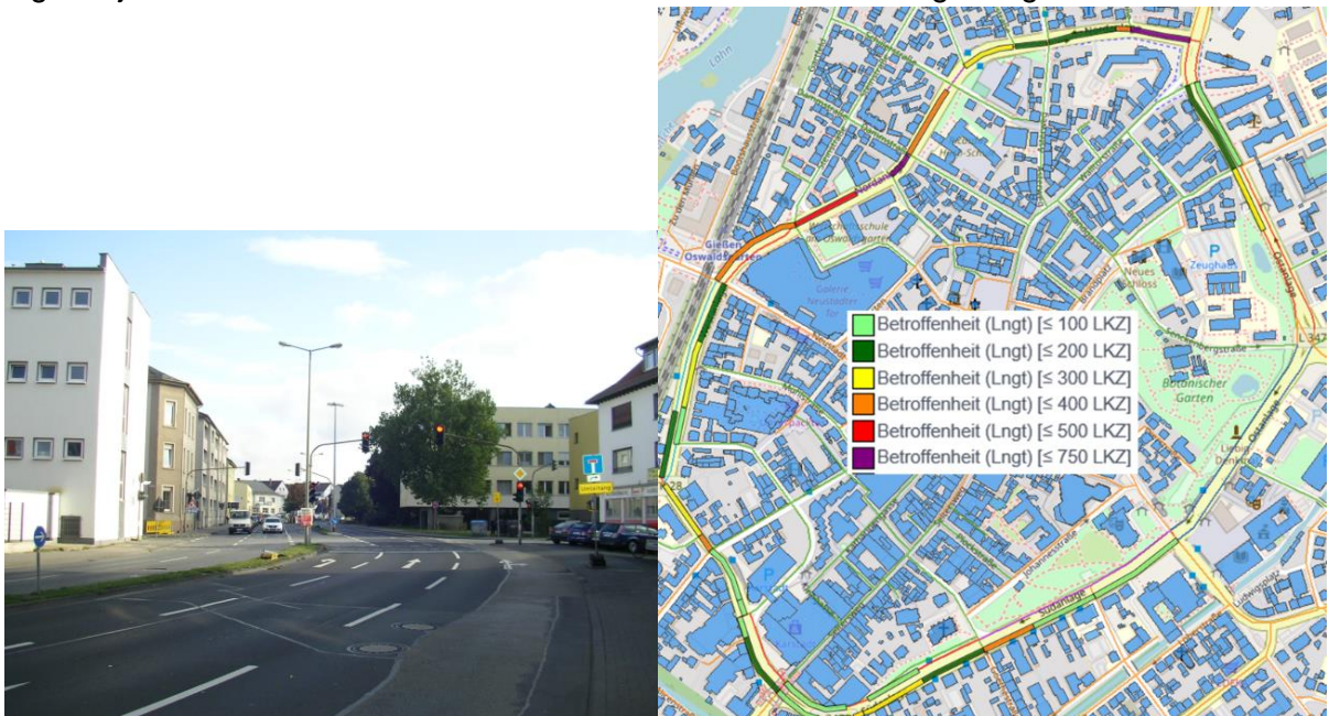
Abbildung 16: Typische Wohnbebauung am Anlagenring (links) und Visualisierung des Lärmkonfliktpunktes durch farbige Bänder der normierten Lärmkennziffern. 5354
